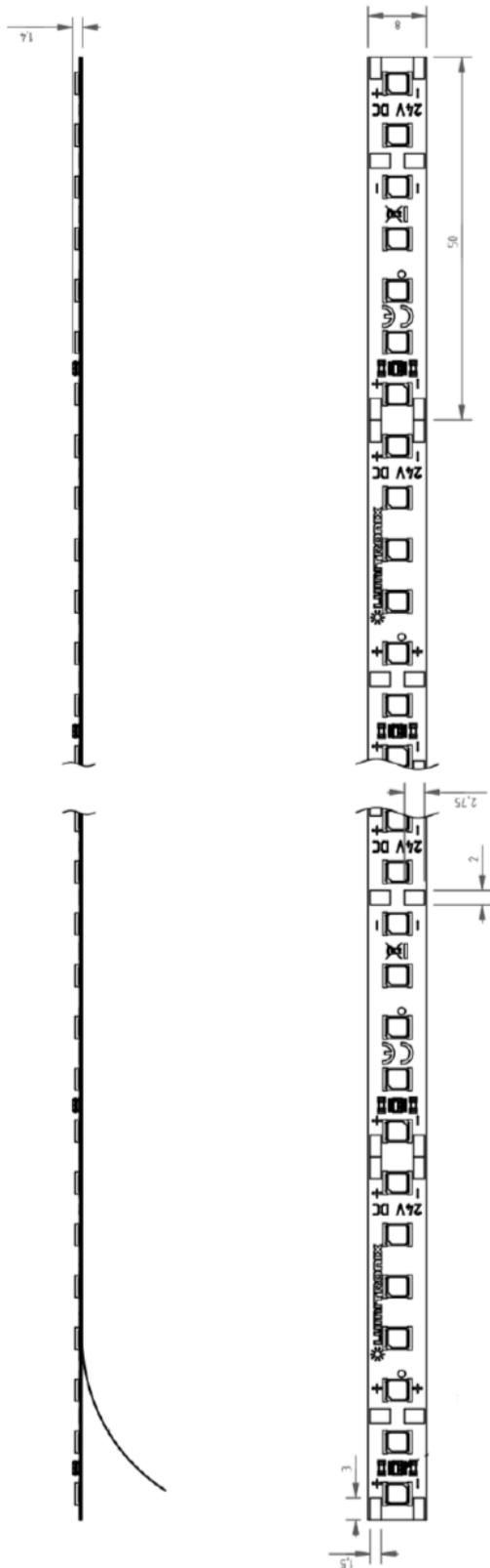
LUMIFLEX3098+ TOSHIBA-SSC LED STRIP SUNLIKE CRI98 PURE WHITE 4000K 8510LM 24V 140 LEDS/M 5M REEL
