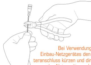
Bei Verwendung eines Einbau-Netzgerätes den Adapteranschluss kürzen und direkt an das Netzgerät anschließen.
