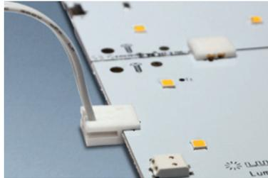
Mit den Kabel-Verbindern lassen sich auch Abstände und Ecken realisieren
