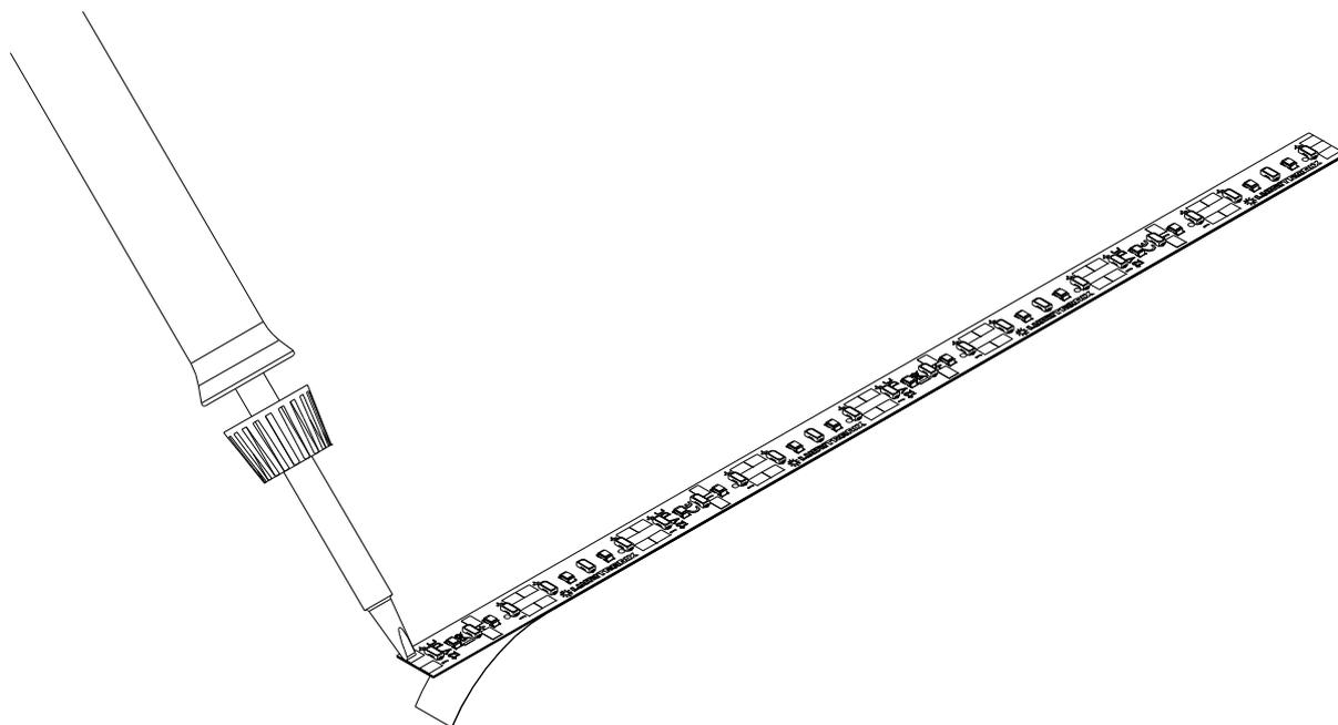
Der Anschluss der LumiFlex Economy LED Module erfolgt über eine Lötverbindung an den dafür vorgesehenen Anschluss pads. Alternativ können gängige Flexleisten-Verbinder verwendet werden.
