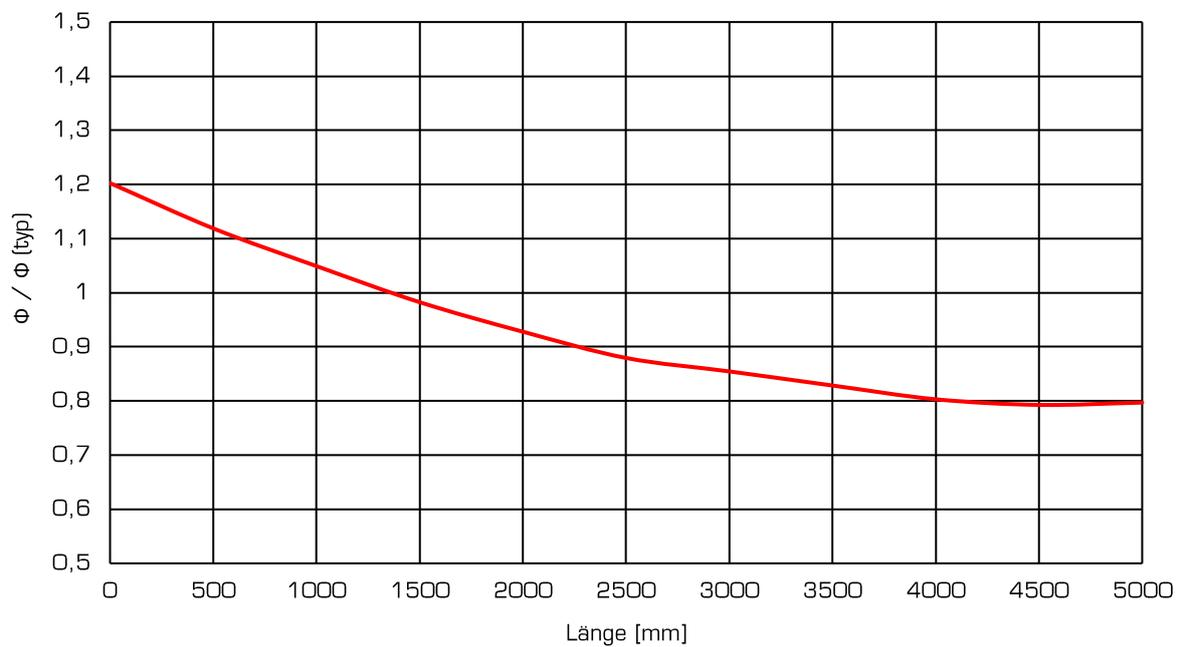
Lichtstromverteilung ausgehend von einer einseitigen Einspeisung über eine Länge von 5m.
