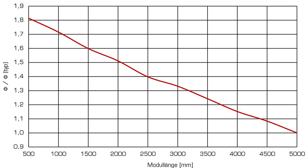
Lichtstrom bei verschiedenen Modullängen. Ausgehend von einer einseitigen Einspeisung.
