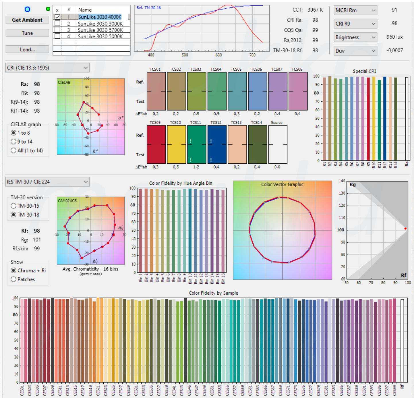
LUMIBAR-56-3098+ TOSHIBA-SSC LED STRIP SUNLIKE CRI98 PURE WHITE 4000K 1513LM 700MA 16V 48 LEDS 56CM MODULE
